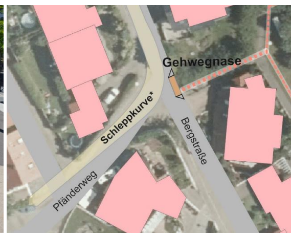
Abbildung 11: Beispiel für eine provisorische Gehwegnase; Skizze der Gehwegnase mit Schleppkurve
